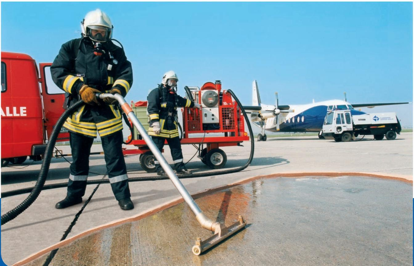
Bei gefährlichen Einsätzen wird gerne auf chemikalienbeständige Masterflex-Absaugschläuche zurückgegriffen
