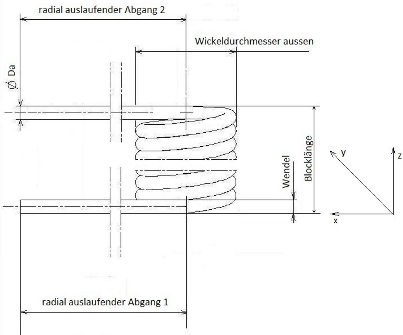
Eine Wendel ist ein gleichmäßig in Z-Richtung auseinandergezogener Kreis. Die Windung (Wendel) beginnt an dem Punkt, wo der Schlauch in die Kreisform übergeht und endet nach einer 360° Wicklung auf der Höhe des Startpunktes der Z-Achse.
