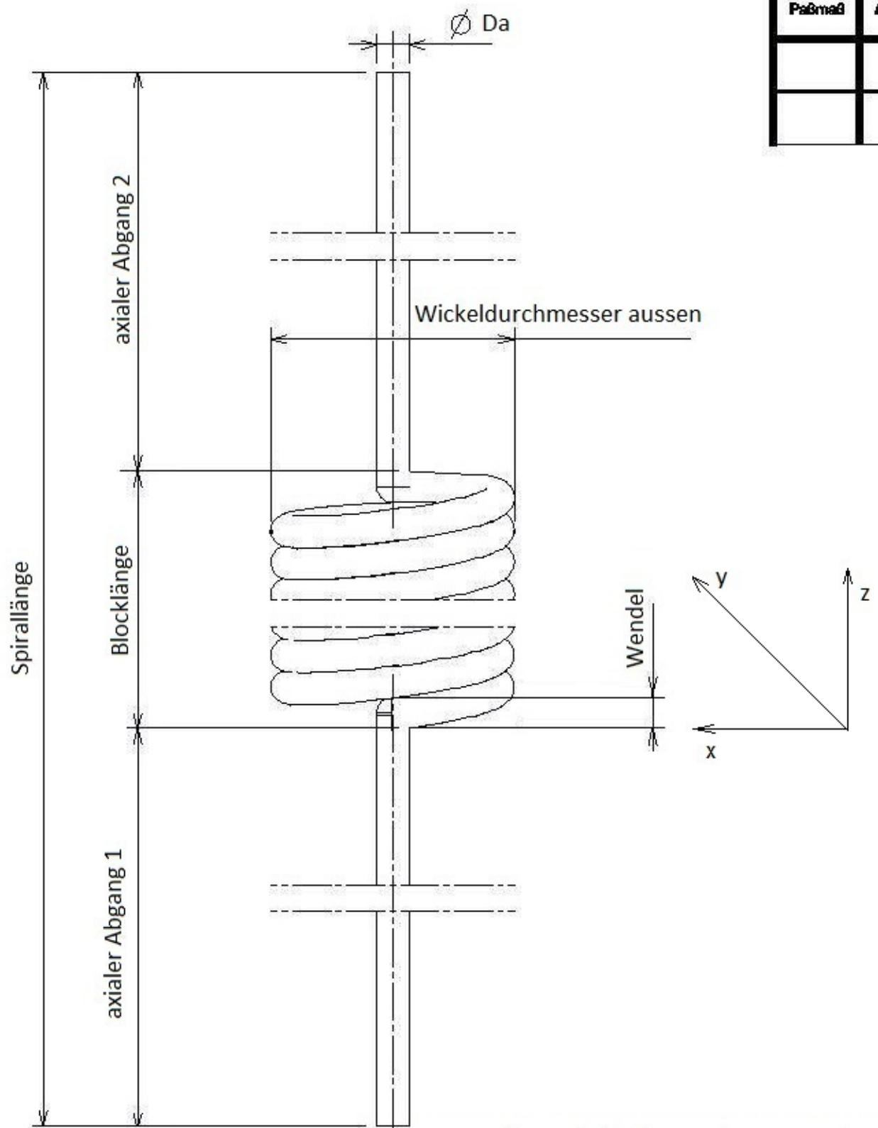
Eine Wendel ist ein gleichmäßig in Z-Richtung auseinandergezogener Kreis. Die Windung (Wendel) beginnt an dem Punkt, wo der Schlauch in die Kreisform übergeht und endet nach einer 360° Wicklung auf der Höhe des Startpunktes der Z-Achse.
